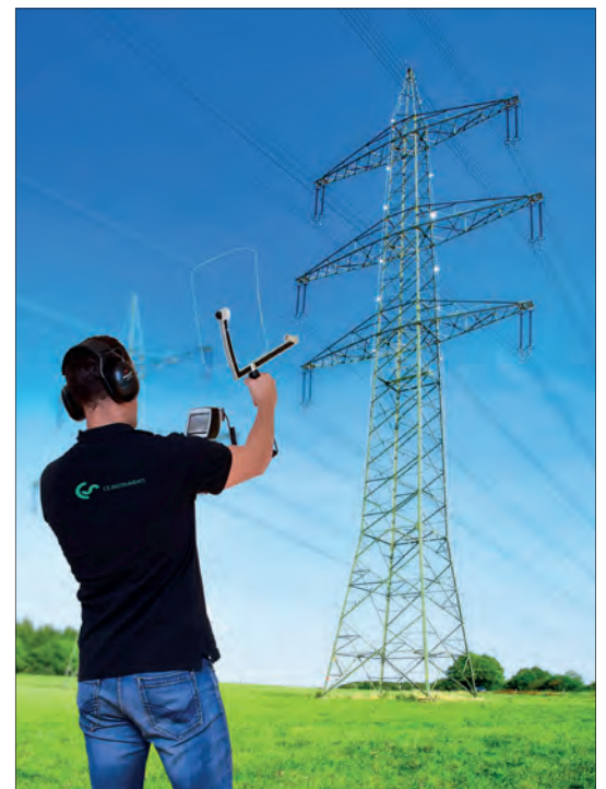
Überprüfen von Hochspannungs-Freileitungen auf Koronaentladung
